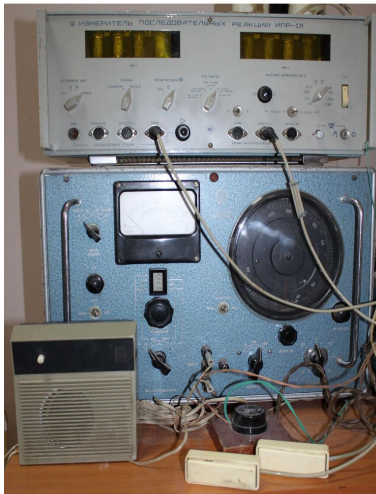
Рис. 24. Обладнання для визначення прихованого (латентного) періоду простої аудіомоторної реакції
